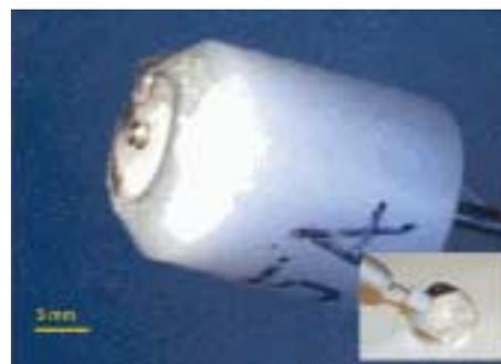
Abbildung 3: Funktionsmuster der entwickelten Laser-/Ultraschallapplikatoren, links: Miniaturwandler, aktive Fläche 0,5 x 0,6 mm mit azimuthaler Krümmung, Frequenz 23 MHz; rechts: Ringwandler mit 1 mm Bohrung und äußerem Durchmesser 3 mm, Frequenz 32 MHz.
