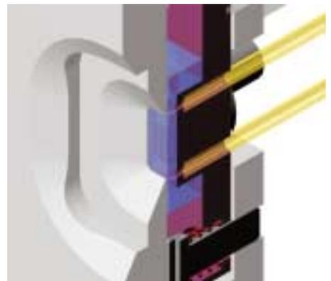
Integration eines Biochips mit optischem »Read-out« in ein mikrofluidisches Subsystem.
