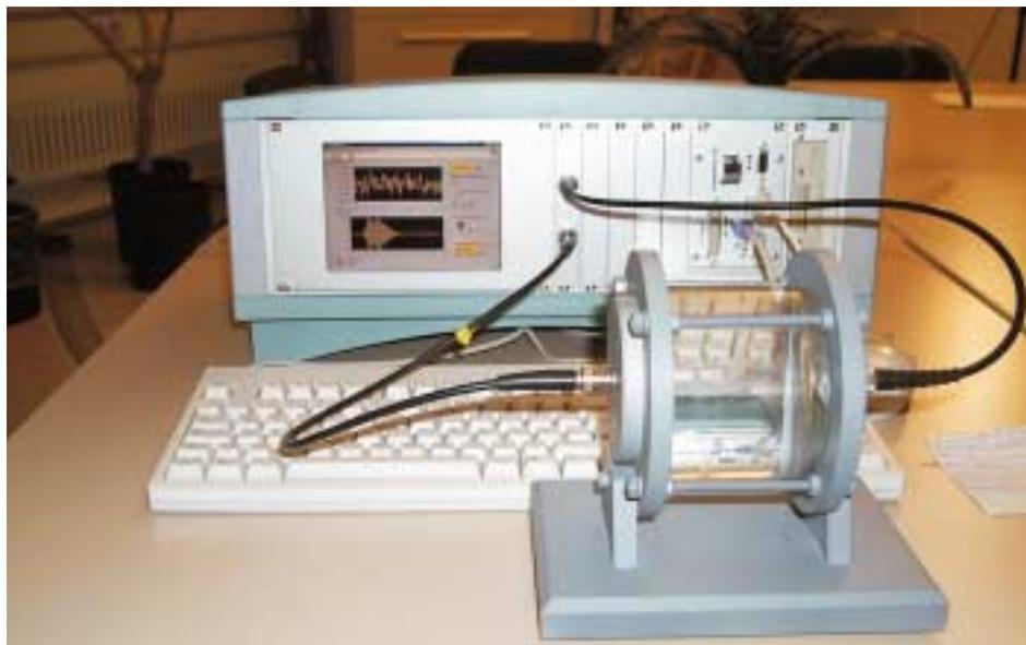
Abbildung 2: Zeroflow-Performance Messsystem mit Delayline zur Kalibrierung.
