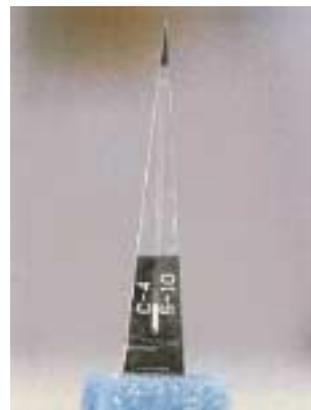
Multipipetten-System mit mikrofluidischer Ansteuerung zum Transport einzelner Zellen.
