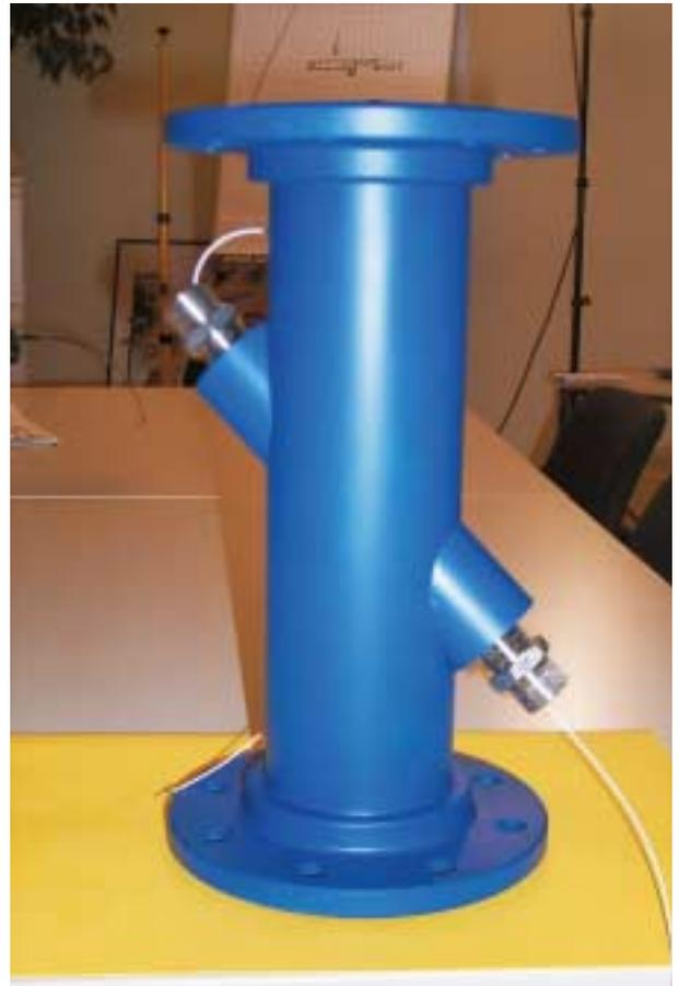
Abbildung 3: IBMT-Messrohr für das Laufzeitdifferenz-Verfahren.
